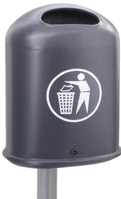
Der Topseller in Deutschland ist formschön, zweckmäßig und praktisch zugleich. Abfallbehälter aus Stahlblech feuerverzinkt. Entleerung erfolgt durch Öffnen der Bodenklappe. Die kleine Einwurföffnung verhindert das Befüllen mit sperrigem Abfall. Farbgestaltung (Pulverbeschichtung) nach RAL.
